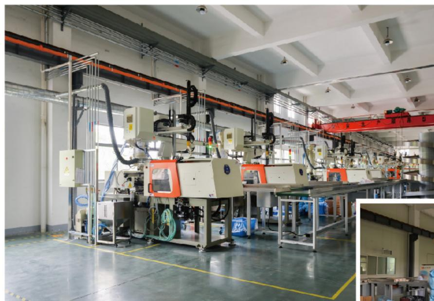
为了三能生产之塑料制品符合国家规定的QS要求，三能器具（无锡）有限公司于2015年3月新增塑料制造车间，按QS申领规定每个细节严格管控；同时从台湾引进先进的数控注塑机，配置专业机器人手臂，实现自动化生产，并于2016年3月顺利通过QS认证。
